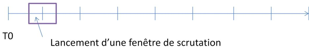
Le schéma ci-dessus représente là où se place notre fenêtre de scrutation de présence en mémoire d'une image du flux vidéo. Chaque cran du chronogramme représente une mise en mémoire d'une image du flux vidéo par la caméra.
