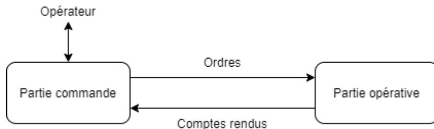
Figure 1 Décomposition d'une machine numérique
