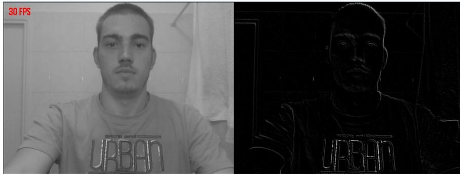
FIGURE 4.2 – Détection de contours par Kirsh
