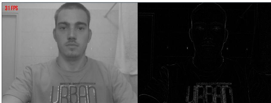
FIGURE 4.3 – Détection de contours par Laplacian
